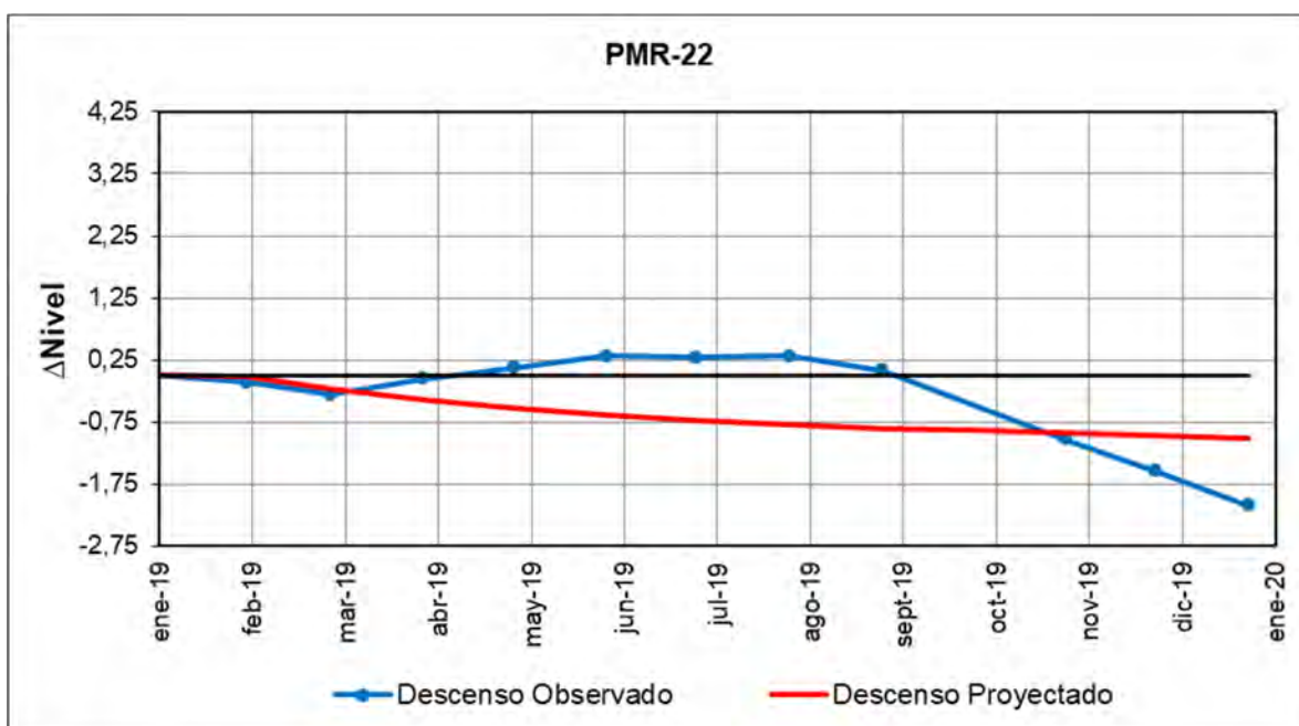
Figura 5.160: Variación de nivel observado y proyectado pozo PMR-22.
